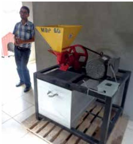
La machine à dépulper permet de retirer la coque du café pour isoler les grains pour travailler efficacement et obtenir une meilleure qualité.
