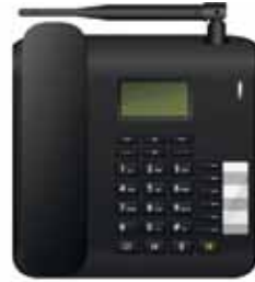
Illustration 5 : Téléphone multimédia spécialement conçu pour AMRC à 450 MHz et services à valeur ajoutée pour l'inclusion financière et numérique via le réseau NPSCS à 450 MHz
