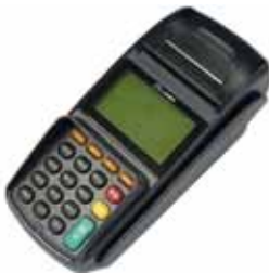
Illustration 4 : Terminal de paiement spécialement conçu pour AMRC à 450 MHz et usage direct sur le réseau NPSCS à 450 MHz
